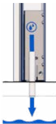
Desagüe a través del anclaje
